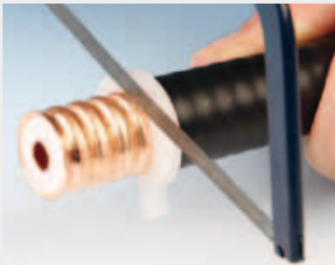
Absetzen mit Sägelehre Trimming with cutting guide
